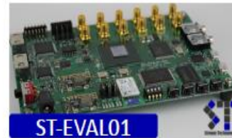
圧縮技術試作用のボード Xilinx社 Artix7 200Tを搭載
