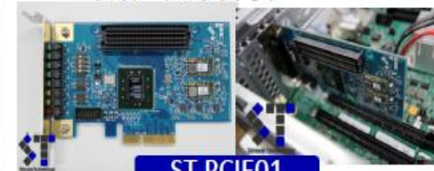
圧縮アクセラレーションボード Xilinx社 Kintex-7を搭載
